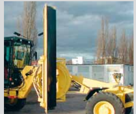
Поворотный круг по выбору с подшипниками скольжения или на роликоподшипниках, угол для откосов 90° справа и слева
