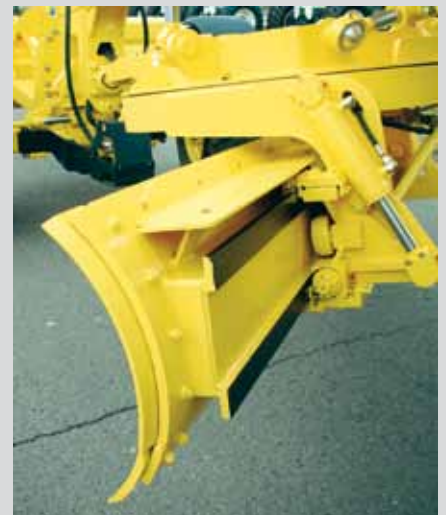
Гидравлическая бесступенчатая установка угла подрезки лемеха.
