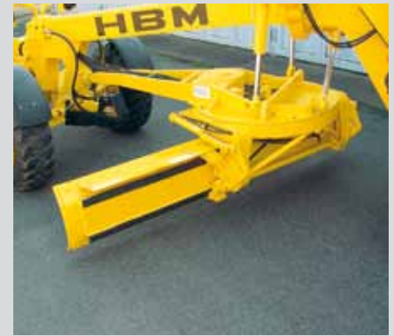
Отработанная кинематика для быстрой установки требуемого положения лемеха.
